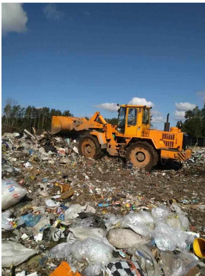
Рисунок 1.2 – Погрузчик-компактор отходов АМКОДОР 352СА с металлическими колесами
