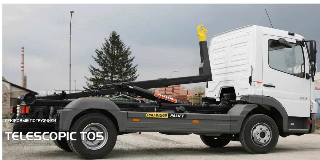
Рисунок 1.1 -Внешний вид МАЗ 4371W1-411 с крюковым погрузчиком Palfinger ST05_L3805
